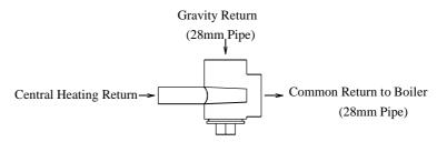
Fig. 7. Injector Tee.
